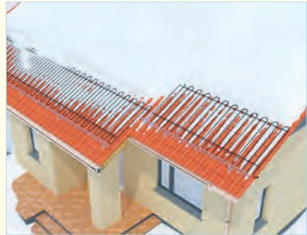
Die Anschluss- und Endabschlussmuffen müssen ebenfalls auf der Dachfläche verlegt werden (Brandschutz). Die Verlegung des Heizsystems ist nur auf Ziegel-, Betonziegel- und Metalldächern zulässig. Die Verlegung auf Holz-, Kunststoff-, Teer-, Asphalt-, Bitumen- und Foliendächern ist nicht zulässig (hierbei sind selbstlimitierende Heizbänder zu verwenden – Informationen und geeignete Produkte erhalten Sie auf Anfrage).
