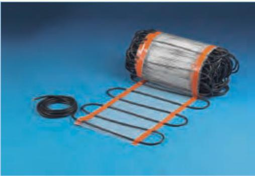
Das Heizsystem ist für die Verlegung im Estrich, Magerbeton, Mörtel- oder Sandbett (kein Splitt) geeignet. Durch die Vermattung auf ein formstabiles Trägernetz sind die Heizmatten besonders schnell zu montieren. Die verlegefertigen Heizmatten werden durch Einschneiden und Umklappen des Trägernetzes an die zu beheizende Fläche angepasst.
