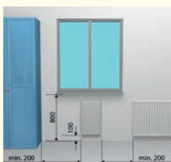
Schematischer Aufbau bei monolithischer Bauweise. Bei Wärmedämmverbundsystemen und Holzständerbauweisen ist die Einbauart entsprechend dem Wandaufbau anzupassen.
